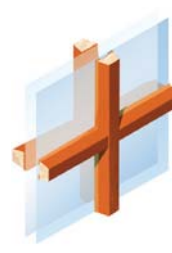
Aufgeklebte Sprossen 26mm ohne Duplex.
