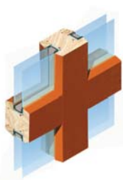
Konstruktions Sprossen Breite: 103, 78, 52mm.
